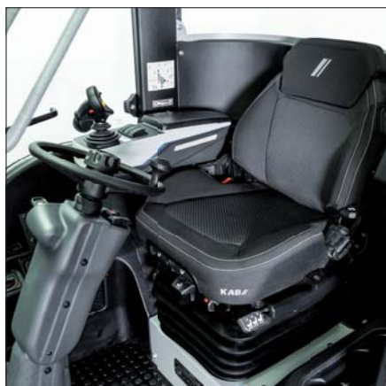
Cabine de conduite indépendante avec siège confortable à suspension pneumatique, chauffage du siège et amortissement longitudinal
